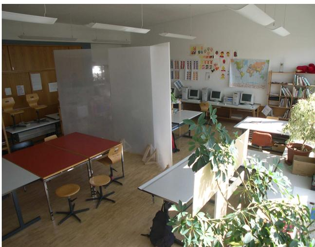
**Abbildung 4:** Klassenzimmer ohne (oben) und mit (unten) transparenten mikroperforierten Stellwänden.
